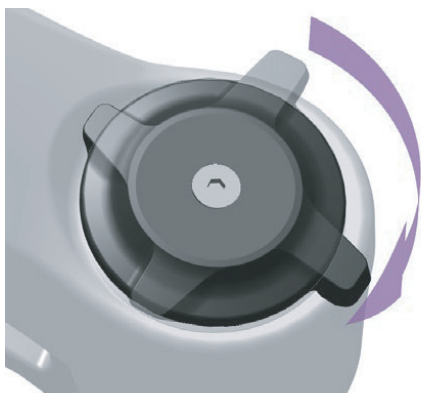
Abbildung 124: Druckstufeneinsteller härter einstellen
