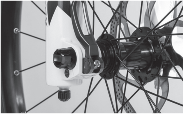
Abbildung 55: Perfekte Lage des Spannhebels
