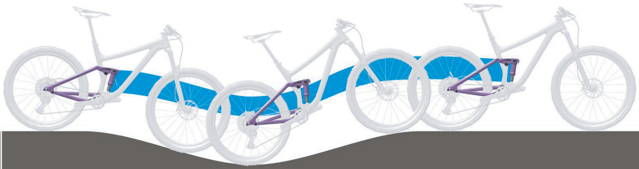
Abbildung 91: Optimales Fahrverhalten des Hinterbau-Dämpfers im hügeligen Gelände
