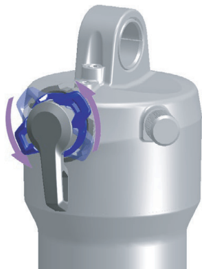
Abbildung 134: Druckstufeneinsteller weicher einstellen
