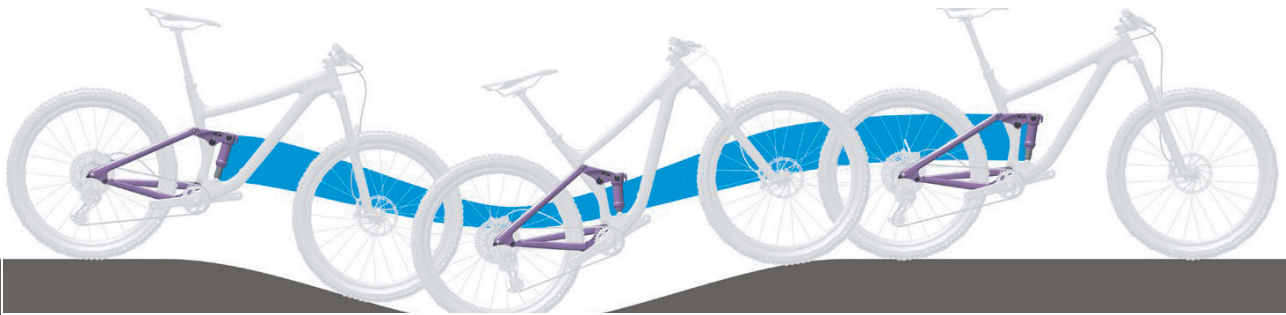
Abbildung 131: Zu weiche Federung des Hintebau-Dämpfers am Berg
