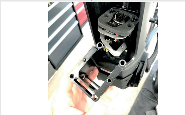
Abbildung 35: PowerTube Adapter herausziehen
