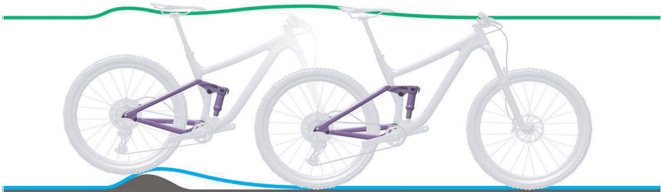
Abbildung 133: Zu harte Dämpfung des Hinterbau-Dämpfers bei Unebenheiten
