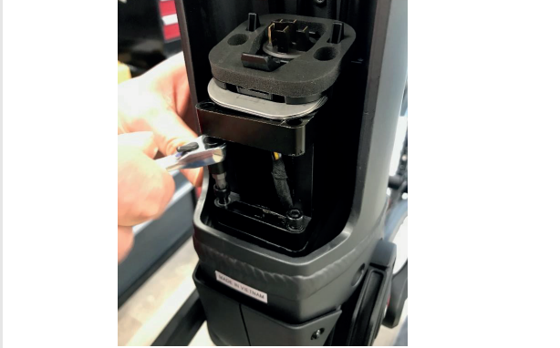
Abbildung 33: 4 mm 6-Kant-Schrauben entfernen
