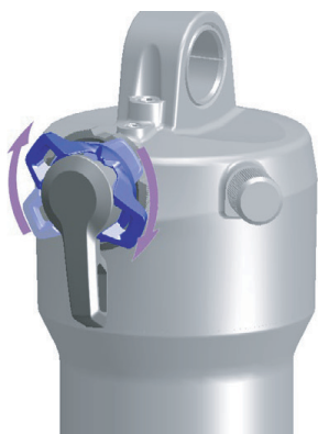
Abbildung 132: Druckstufeneinsteller härter einstellen
