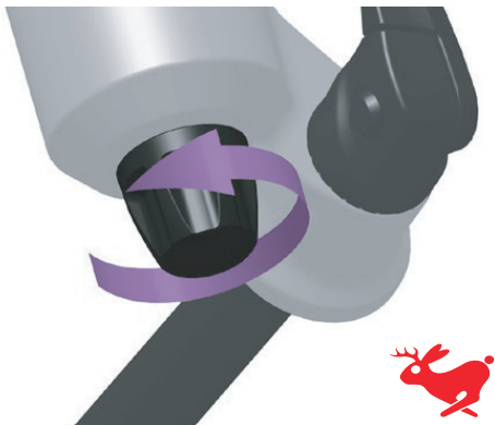
Abbildung 122: Zugstufendämpfer in Richtung Hase drehen
