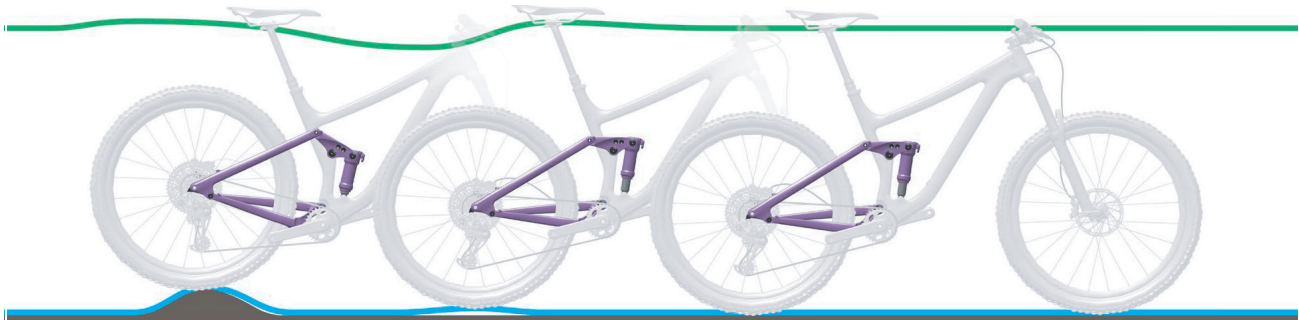
Abbildung 127: Zu schnelles Ausfedern des Hinterbau-Dämpfers
