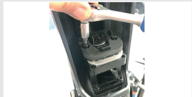
Abbildung 32: Akkuhalter Schrauben lösen
