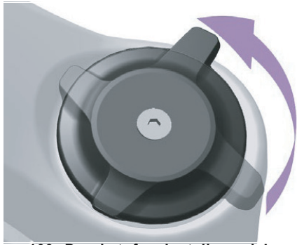
Abbildung 109: Druckstufeneinsteller weicher einstellen
