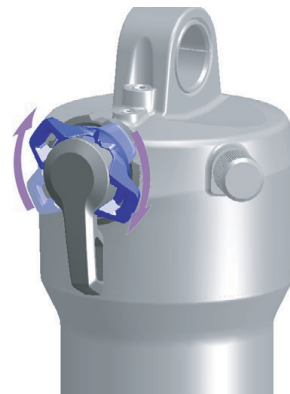
Abbildung 94: Druckstufeneinsteller härter einstellen
