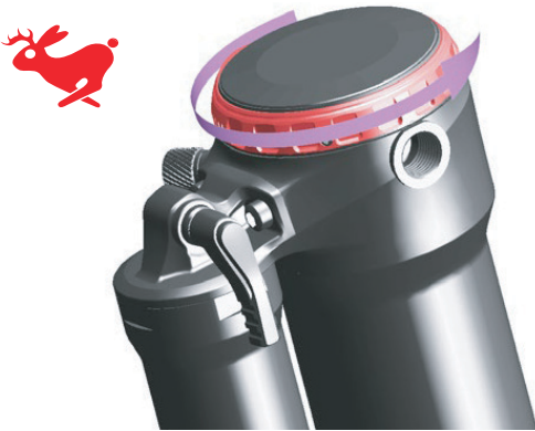
Abbildung 130: Zugstufendämpfer in Richtung Hase drehen
