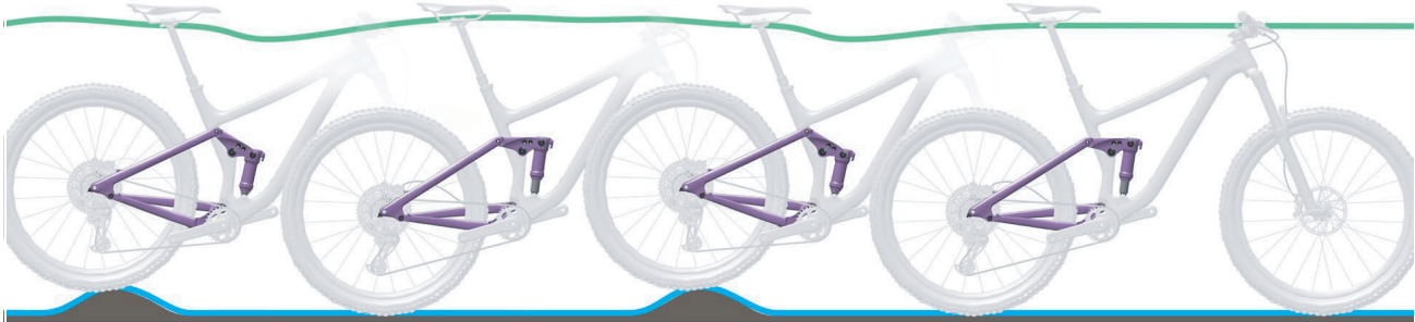
Abbildung 10: Optimales Fahrverhalten des Hinterbau-Dämpfers
