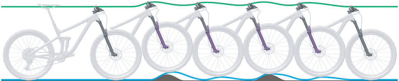
Abbildung 119: Zu schnelles Ausfedern der Federgabel
