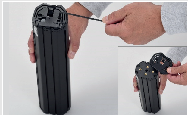
Abbildung 41: Demontage oberes Interface
