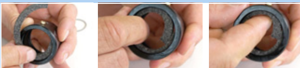
Afbeelding 183: Vilten ring inleggen
