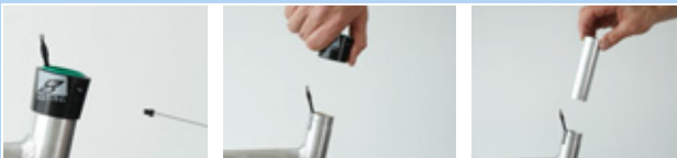
Afbeelding 143: Buitenhuls en glijbus demonteren
