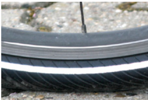
Afbeelding 79: Juiste vuldruk. De band is onder de belasting van het lichaamsgewicht nauwelijks vervormd
