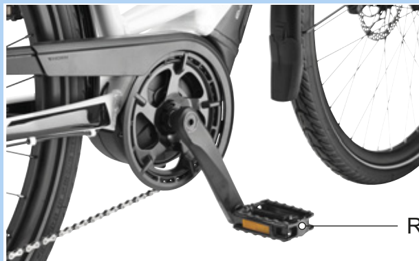
Illustration 57 : Pédale R dans le bras de manivelle droit
