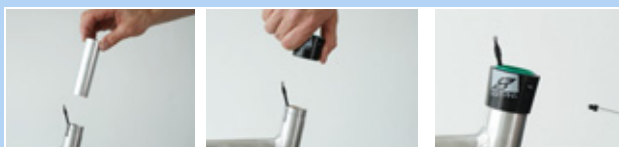
Illustration 156 : Monter la douille de glissement et l'enveloppe extérieure
