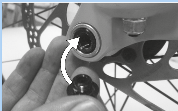
Illustration 43 : Enfoncez le levier d'attache rapide dans l'axe
