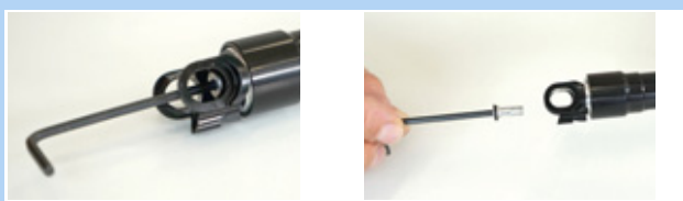
Illustration 152 : Retirer le capuchon de valve
