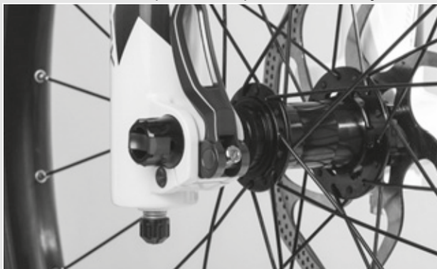
Afbeelding 21: Perfecte stand van de spanhendel
