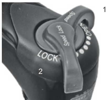
Afbeelding 49: Suntour drukdemperafsteller met de standen OPEN (1) en LOCK (2)
