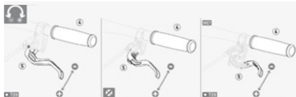
Afbeelding 41: Grijpafstand remhendel Magura schijfrem afstellen
