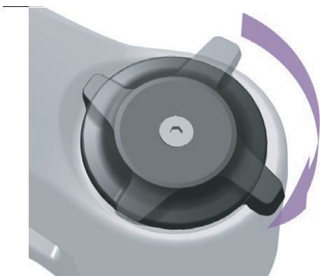
Abbildung 74: Druckstufeneinsteller härter einstellen
