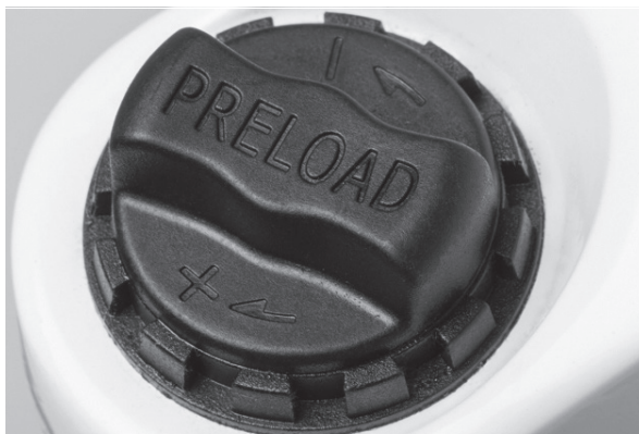
Abbildung 44: Einstellrad SAG auf der Krone der Federgabel
