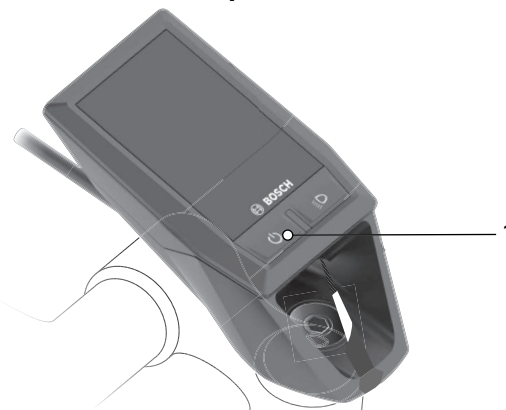
Abbildung 55: Lage Ein-Aus-Taster (Bedieneinheit)
