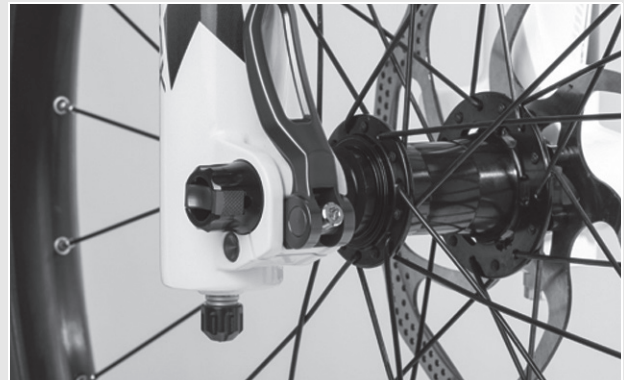
Abbildung 31: Perfekte Lage des Spannhebels
