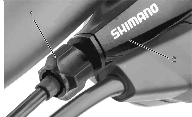
Abbildung 66: Einstellhülse (1) der einzügigen, seilzugbetätigten Gangschaltung mit Schalthebelgehäuse (2), Beispiel
