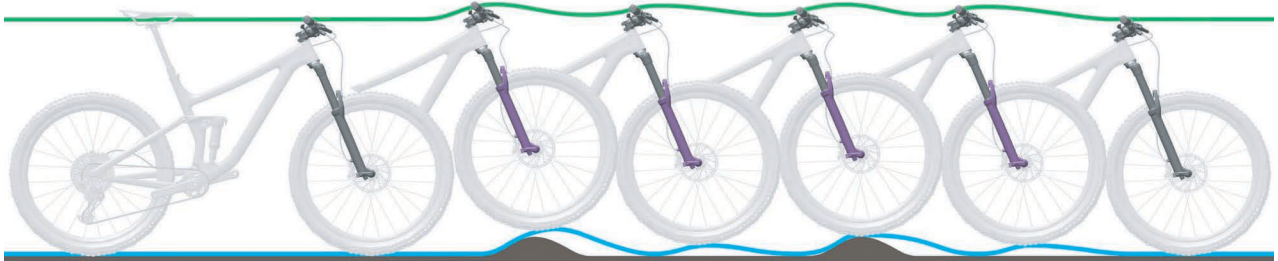
Abbildung 69: Zu schnelles Ausfedern der Federgabel
