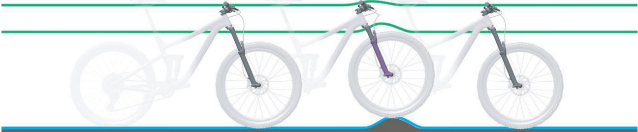
Abbildung 6: Optimales Fahrverhalten der Gabel bei Unebenheiten
