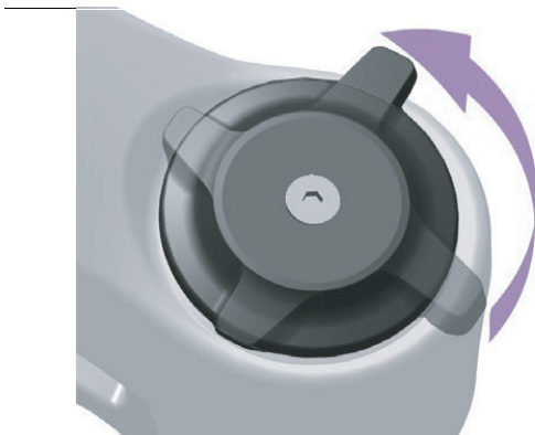
Abbildung 76: Druckstufeneinsteller weicher einstellen
