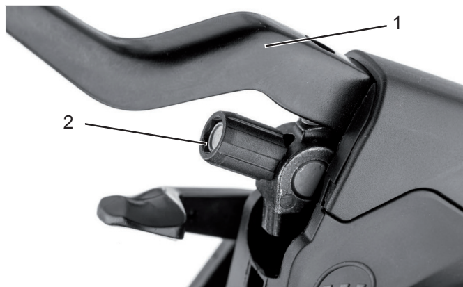
Abbildung 64: Bremshebel (1) der hydraulisch betätigten Felgenbremse mit Einstellschraube (2)
