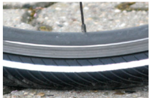
Figura 84: Presión de inflado correcta. La cubierta apenas está deformada bajo la carga del peso corporal
