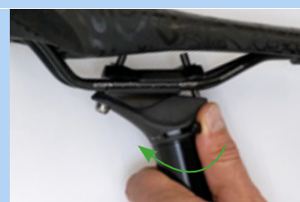
Figura 188: Cierre del ajuste de altura
