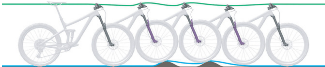
Figura 196: Descompresión demasiado lenta de la horquilla de suspensión
