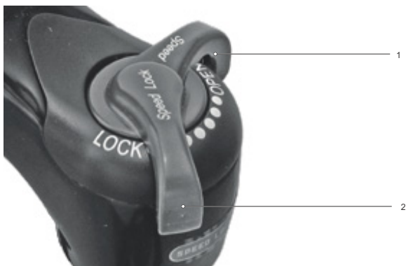
Figura 199: Ajuste para un regulador de niveles de presión más duro
