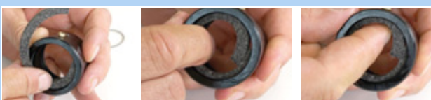
Figura 180: Inserción del anillo de fieltro
