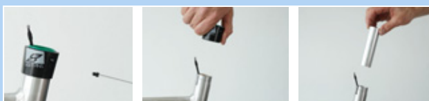
Figura 140: Desmontaje del manguito exterior y del casquillo deslizante
