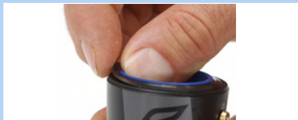
Figura 175: Retirada del anillo con falda de obturación
