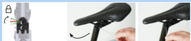
Figura 169: Cierre del ajuste de altura
