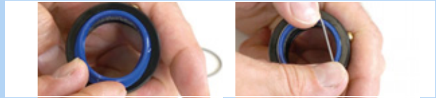
Figura 181: Inserción y fijación del rascador
