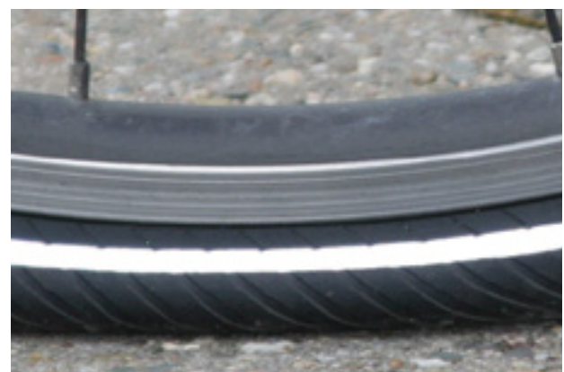
Figura 85: Presión de inflado demasiado baja
