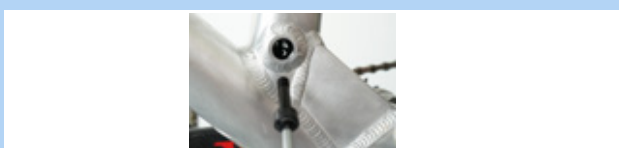
Figura 135: Soltar el eje Postpin
