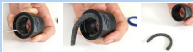
Figura 143: Retirada del anillo de fieltro
