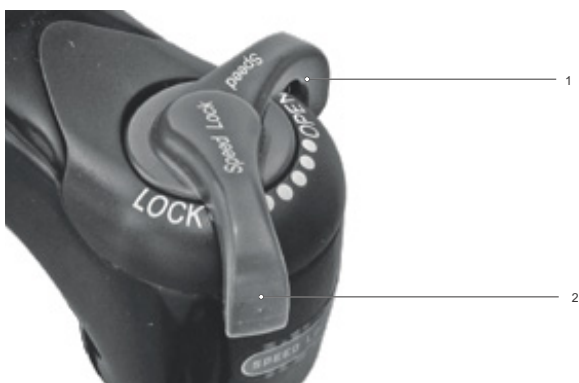
Figura 201: Ajuste para un regulador de niveles de presión más blando
