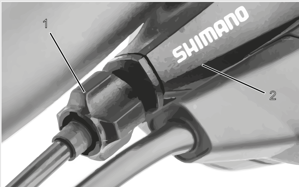
Illustration 56 : Douille de réglage (1) du changement de vitesse à un câble actionné par câble avec boîtier de manette de vitesse (2), exemple
