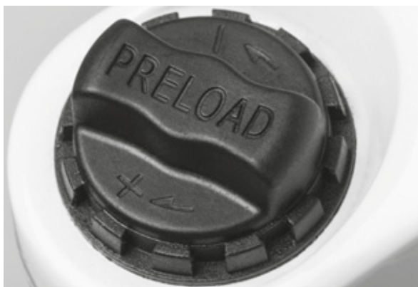
Illustration 43 : Molette de réglage de la course de suspension négative sur la couronne de la fourche de suspension
