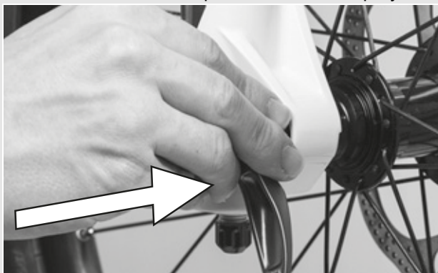
Illustration 24 : Enfoncez l'attache rapide
