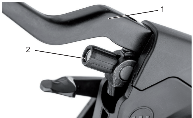
Abbildung 55: Bremshebel (1) der hydraulisch betätigten Felgenbremse mit Einstellschraube (2)
